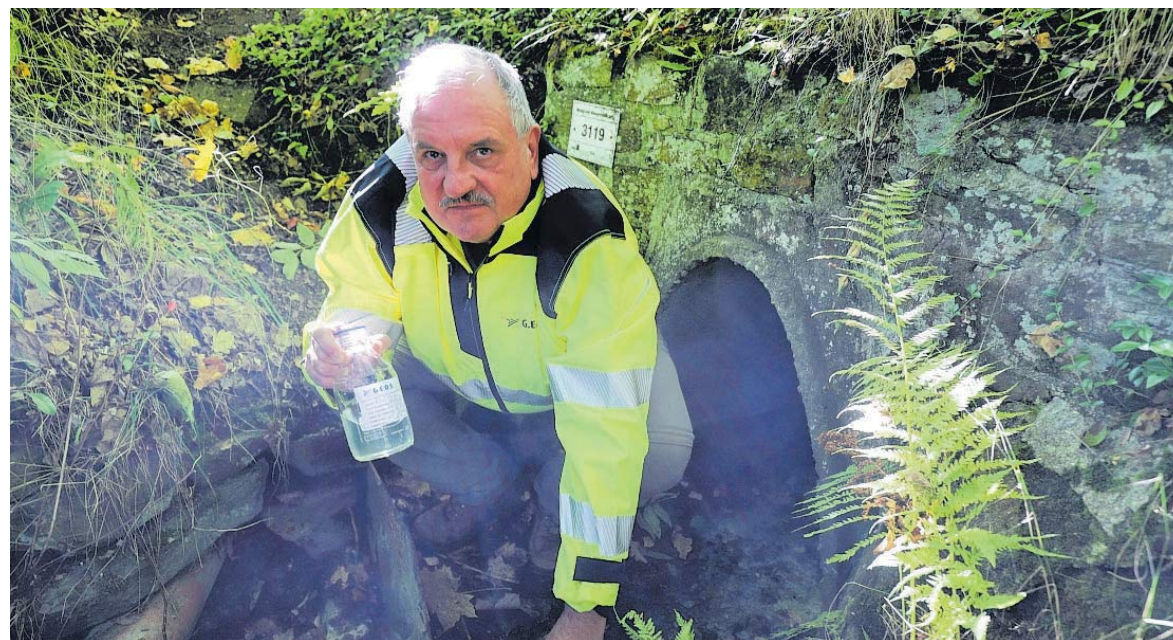
Geos-Projektleiter Mirko Martin entnimmt am Fuß der Hammerberg-Spülhalde eine Probe des Sickerwassers.
