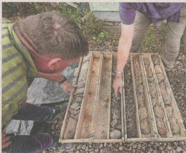
An sieben Stellen wurden in unterschiedlichen Tiefen des Augustusschachtes an der Rotkopf-Görg-Straße in Freital Bohrkernentnommen. Die Gesteinsschichten werden nun in Freiberg untersucht.
